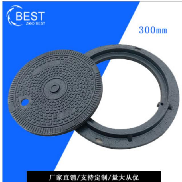
新型环保玻璃钢模压复合承重井盖是一种\*\*井盖,采用先进工艺及设备模压成型,该产品具有密封、阻燃、防静电、防腐蚀、耐化学溶剂、耐酸碱等特性,\*\*于石油、石化行业及遍布全国各地的加油站及燃气站。加油站\*\*导电防水圆形复合人孔井盖□BEST-500□BEST-600□BEST-700□BEST-900□BEST-993等。每款井盖都是由复合人孔井盖、复合井框和防水密封圈三部分组成,井盖结构面加强设计,常用于加油站前院机动车行驶区域中的人孔井上,承重荷载可以达到国标GB/T23858-2009中C250以上级别。
